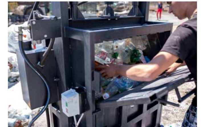
Гідравлічний прес для ПЕТ-тари та макулатури. Липень, 2020 рік / Hydraulic press for PET containers and waste paper. July 2020
