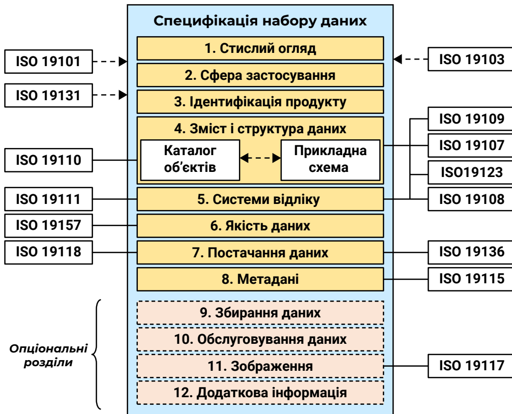
Рис. 3.4. Структура специфікації геоінформаційного продукту та зв'язки вимог до змісту її розділів з міжнародними стандартами серії ISO 19100
