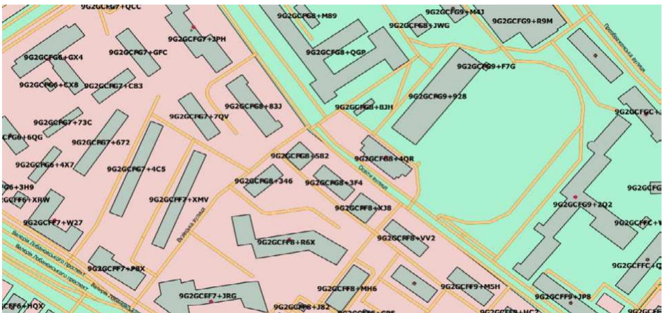
Рис. 4.54. Фрагмент електронного плану з унікальними ідентифікаторами будівель м. Києва на основі OLC довжиною 11 символів [ https://doi.org/10.32347/2076-815x.2020.75.217-232 ]
