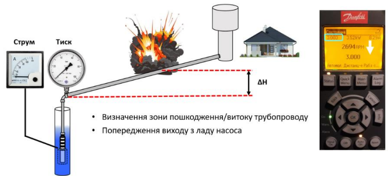
Рис. 5. Використання засобів вимірювання для пошуку зруйнованих ділянок трубопроводів
