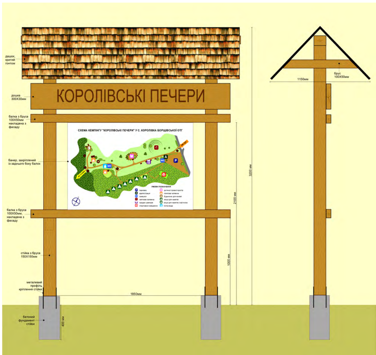
Рисунок 3.1. Ескіз інформаційного стенду для проекту кемпу – громадського простору в селі Королівка Борщівської ТГ, Тернопільська область
