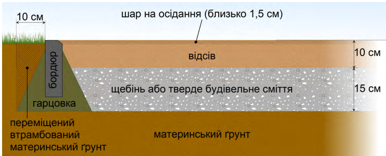
Рисунок 3.4. Схематичний розріз пішохідної доріжки з комбінованим покриттям (гранвідсів та плити)
