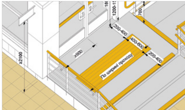
• Попереджувальня ТС перед входом в будівлю.
