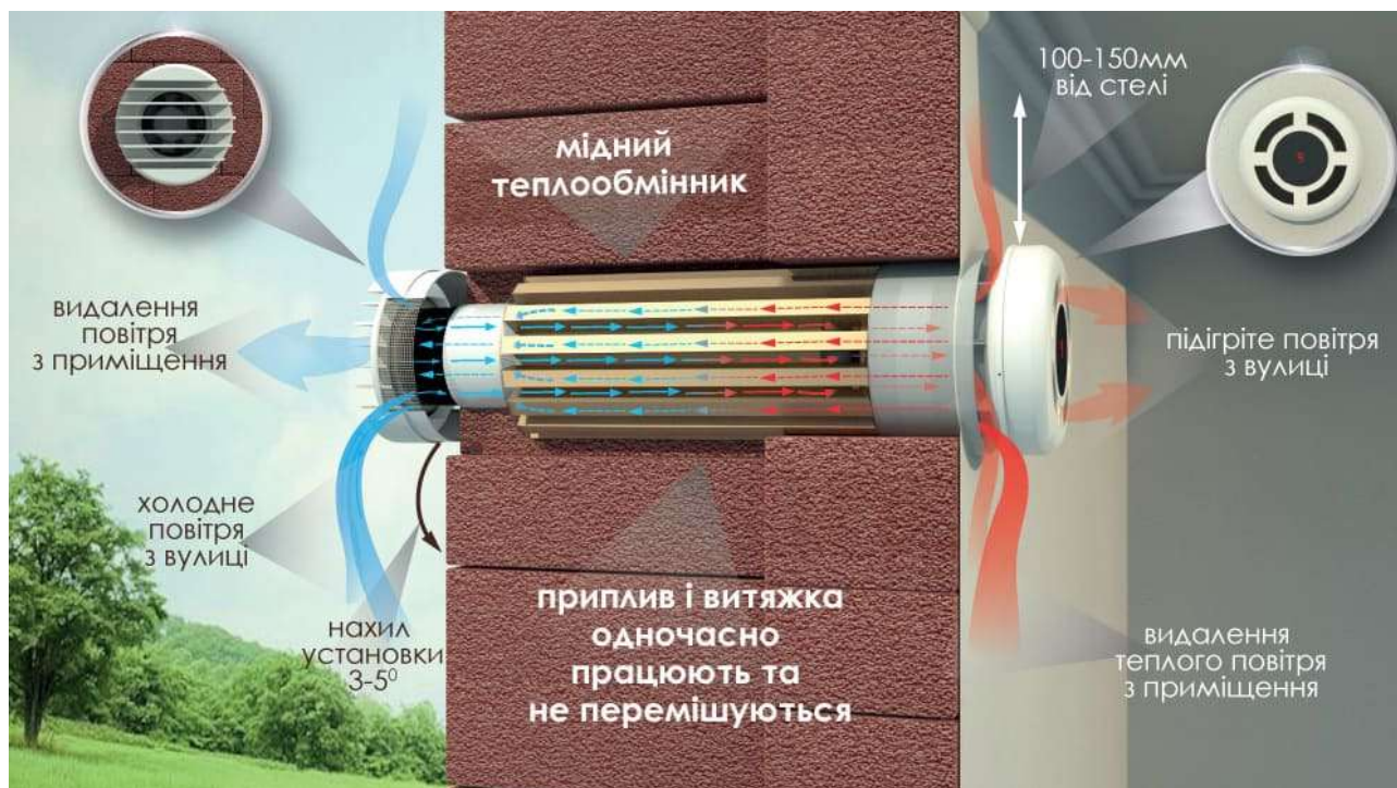
Рис. 5. Принцип роботи вентиляційного рекуператора тепла
