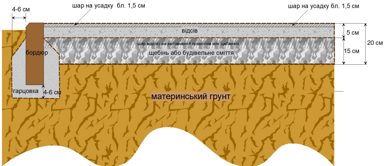
Рис. 6. Схематичний розріз пішохідної доріжки з м'яким покриттям (гранвідсів)
